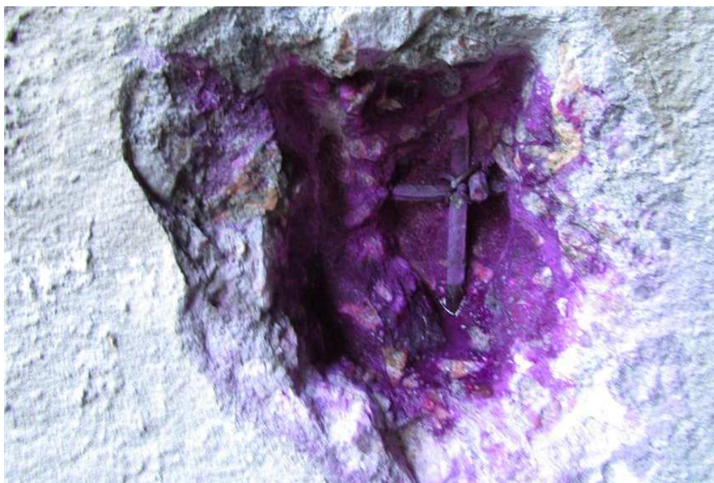
Foto 100 Ponto 04 de ensaio de carbonatação (solução de fenolftaleína). Face Norte da base da Linha de Apoio 1. Encontro Sul.
