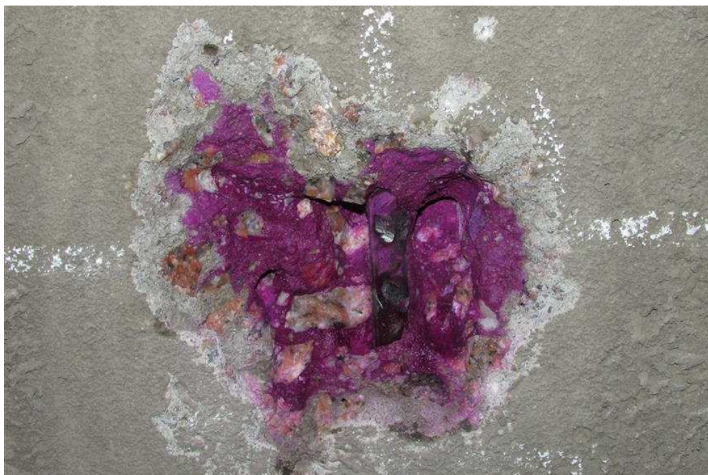
Foto 99 Ponto 03 de ensaio de carbonatação (solução de fenolftaleína). Face Oeste da Viga Longarina VL.3. Próximo da Linha de Apoio 1 – Encontro Sul.
